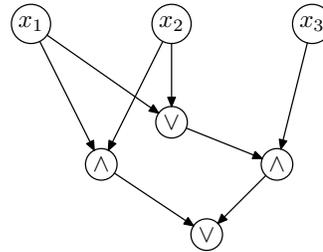
Рис. 14.1: Схема для функции  $x_1 \oplus x_2$ Рис. 14.2: Схема для функции  $MAJ_3$
